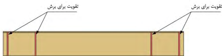
شکل ۱۴-۷۴- ورق سخت‌کننده عمود بر صفحه جان تیر
